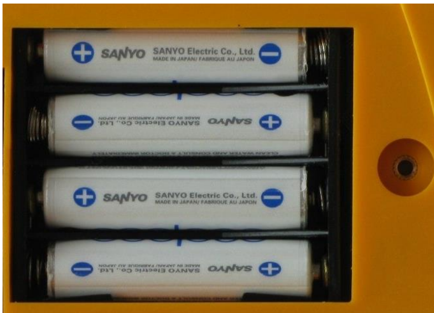
Obr. 4.1 Správná polarita napájecích článků
