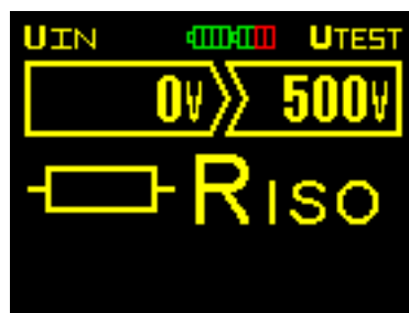
Obr. 3.5 Příklad nastavení pro měření izolačních odporů
