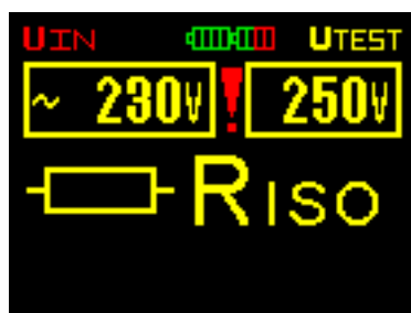
Obr. 3.4a Příklad výsledku měření (zvoleno měření izolačního odporu)
