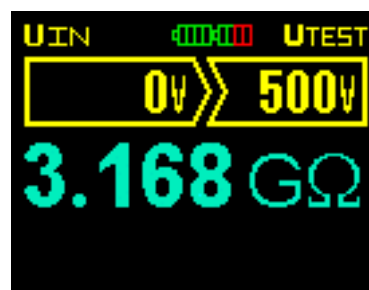
Obr. 3.7b Příklad výsledku měření (náboj je vybit)
