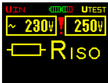
Obr. 3.1 Příklad zobrazení při měření napětí
