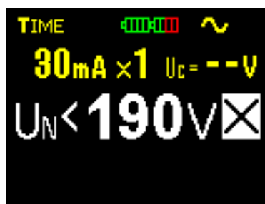
Obr. 3.11 Příklad nastavení pro měření vypínacího času
