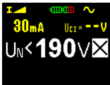
Obr. 3.14 Příklad nastavení pro měření vybavovacího proudu
