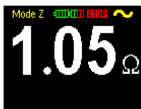
Obr. 3.6a Příklad indikace překročení maximální teploty – symbol STOP
