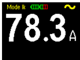
Obr. 3.9 Příklad zobrazení zkratového proudu
