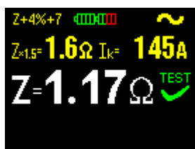
Obr. 3.13 Příklad zobrazení změřené impedance zvýšené o chybu měření
