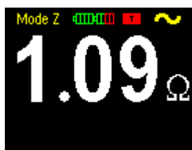
Obr. 3.8a Příklad výsledku měření impedance (stručné zobrazení)
