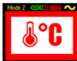
Obr. 3.6b Příklad indikace překročení max. teploty po stisku tlačítka START
