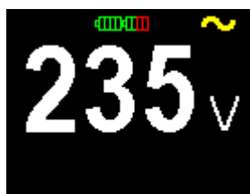
Obr. 3.3a Měření napětí (stručné zobrazení)
