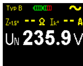
Obr. 3.3b Měření napětí (podrobné zobrazení)
