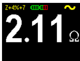
Obr. 3.11 Příklad zobrazení impedance zvýšené o chybu měření
