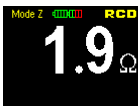
Obr. 3.15a Příklad zobrazení impedance za proudovým chráničem (stručné zobrazení)
