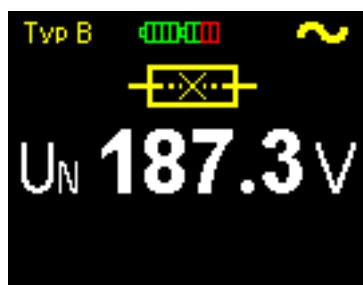
Obr. 3.2 Příklad indikace přerušené pojistky (podrobné zobrazení)
