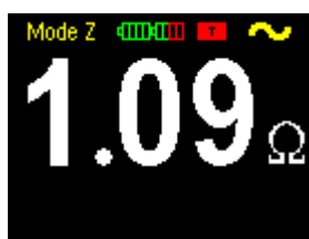
Obr. 3.5a Příklad indikace vysoké teploty (stručné zobrazení)
