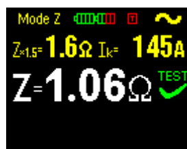
Obr. 3.8b Příklad výsledku měření impedance (podrobné zobrazení)
