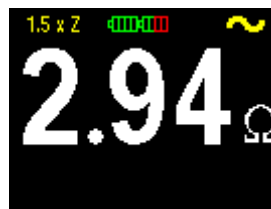
Obr. 3.10 Příklad zobrazení 1,5násobku změřené impedance
