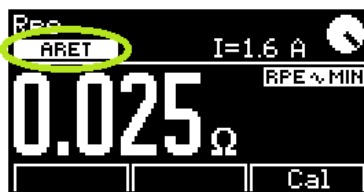
Obrázek 39: Aretace tlačítka [TEST]
