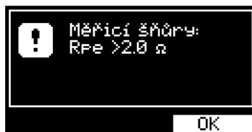
Obrázek 34: Varovné hlášení: Měřicí šňůry: Rpe >2.0 Ω
