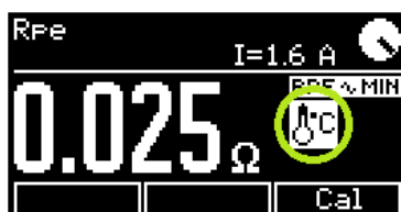
Obrázek 37: Upozornění na zahřívání vnitřních obvodů při měření Rpe
