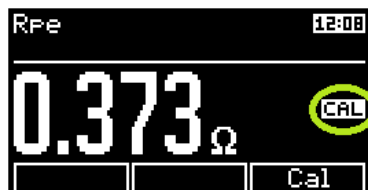
Obrázek 46: Chyba kompenzace odporu měřicích šňůr
