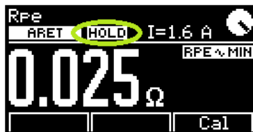
Obrázek 41: Zablokování hodnoty měřené veličiny na displeji
