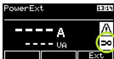
Obrázek 47: Aktivace vstupu pro externí měřicí zařízení
