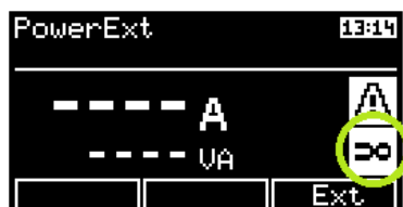
Abbildung 47: Aktivierung des Eingangs für externes Messgerät
