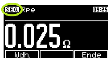
Abbildung 42: Aktivierung des automatischen Arbeitsablaufs
