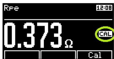
Abbildung 46: Fehler Widerstandsausgleich Messkabel
