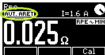
Abbildung 40: Automatisch Arretierung der Taste [TEST]
