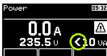
Abbildung 44: Gemessener Wert außerhalb des Messbereichs (min)
