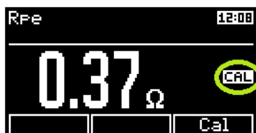
Obrázek 28: Chyba kompenzace odporu měřicích šňůr
