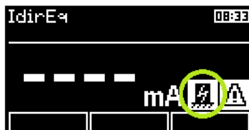
Obrázek 18: Upozornění na nutnost izolovaného uložení spotřebiče
