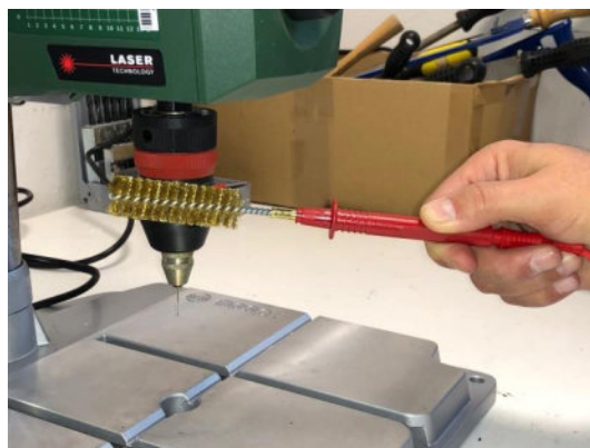
P 3070 – sonda pro snímání dotykového proudu z rotujících částí spotřebičů
