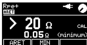
Obrázek 5: Příklad měření odporu ochranného vodiče se záznamem minimální naměřené hodnoty
