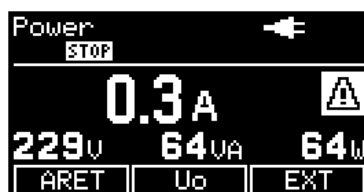
Obrázek 10: Příklad měření proudu, napětí a příkonu
