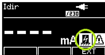
Obrázek 17: Upozornění na nutnost izolovaného uložení spotřebiče
