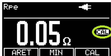
Obrázek 28: Chyba kompenzace odporu měřících šňůr
