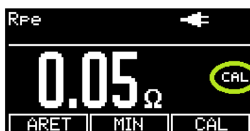
Obrázek 27: Kompensace odporu měřicích šňůr
