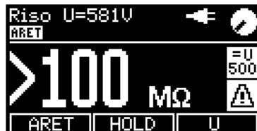
Obrázek 6: Příklad měření izolačního odporu
