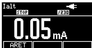
Obrázek 7: Příklad měření unikajícího proudu alternativní metodou
