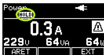
Obrázek 23: Zablokování hodnoty měřené veličiny na displeji
