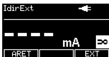
Obrázek 9: Příklad měření unikajícího proudu pomocí externího měřicího zařízení
