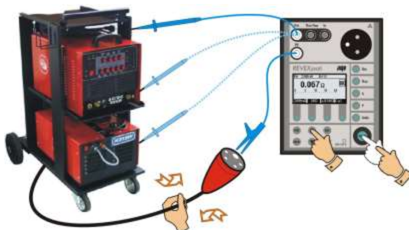
Obr. 2 - Měření odporu ochranného obvodu trojfázové svářečky
