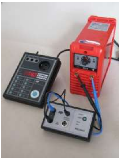
Obr. 15 - Měření napětí svařovacího obvodu
