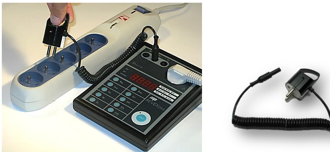
Obr. 5 – Adaptér P 8030 a příklad měření odporu PE prodlužovacích přívodů
