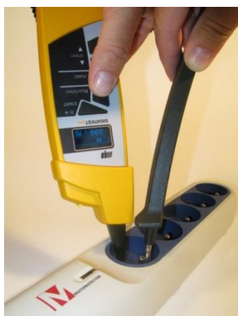
Obr. 3 - Měření miliampérového bodu přepětové ochrany prodlužovačky
