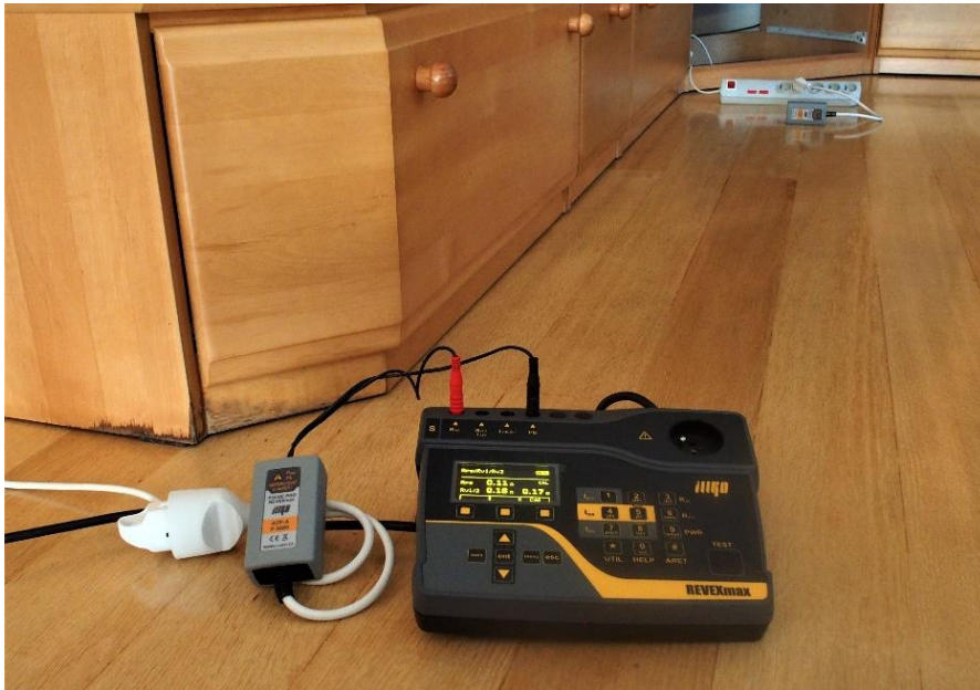
Obr. 8 – Použití adaptéru ATP
