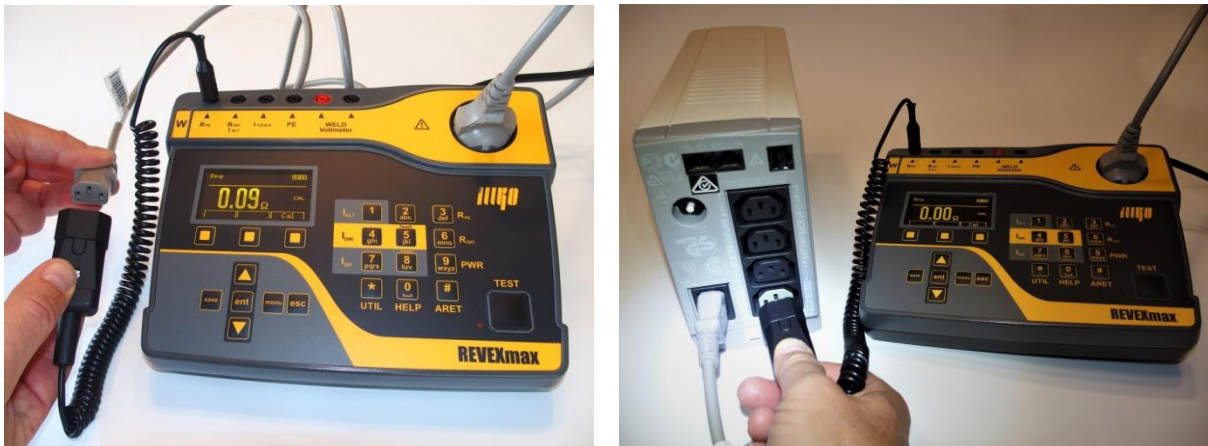
Obr. 6 - Příklad použití adaptéru P 8031 při revizi odpojitelného přívodu a UPS
